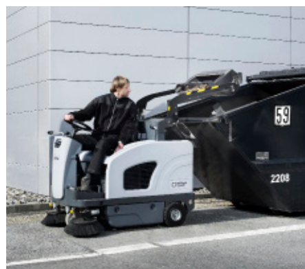
Retráctil y puede cerrar la tolva desde el asiento del operario lo que permite al operador conducir inmediatamente, después de verter al contenedor.
