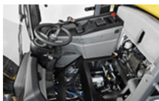
Accesos a mantenimiento en el interior de la cabina
