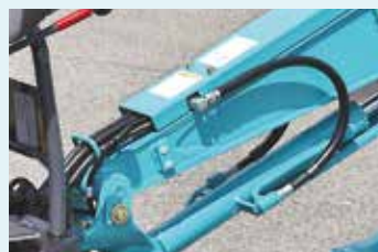
Cubierta protectora para las mangueras detrás del balancín.
