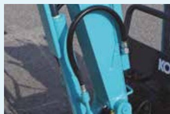
Mangueras de los cilindros del balancín en dos partes.
