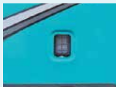
Indicador de nivel del depósito de aceite hidráulico
