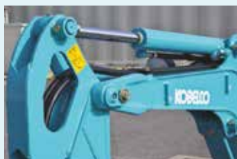
Las mangueras de los cilindros del cazo se tienden dentro del brazo.
