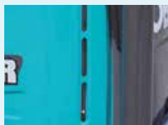
Indicador de nivel del depósito de combustible
