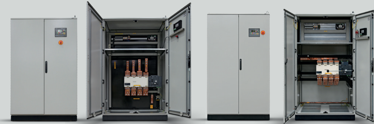
1600 A Conmutador motorizado de 4 polos. Central CEC7. Detección fallo de red. Parada de emergencia. Medición de tensión. 2500-3150 A Conmutador motorizado de 4 polos. Central CEC7. Detección fallo de red. Parada de emergencia. Medición de tensión.
