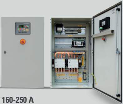
160-250 A Contactores de 4 polos. Central CEA7. Detección fallo de red y control de grupo. Parada de emergencia. Medición de corriente y tensión.
