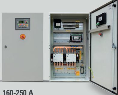
160-250 A Contactores de 4 polos. Central CEA7. Detección fallo de red y control de grupo. Parada de emergencia. Medición de corriente y tensión.
