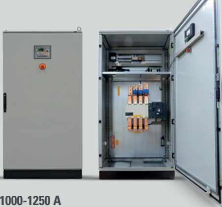
1000-1250 A Conmutador motorizado de 4 polos. Central CEA7. Detección fallo de red y control de grupo. Parada de emergencia. Medición de corriente y tensión.
