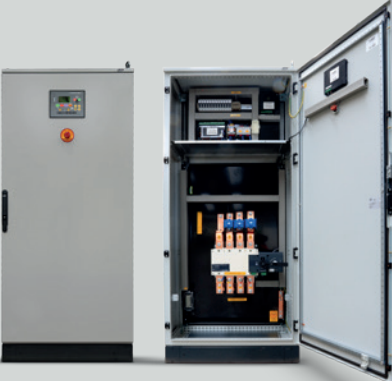
800 A Conmutador motorizado de 4 polos. Central CEA7. Detección fallo de red y control de grupo. Parada de emergencia. Medición de corriente y tensión.
