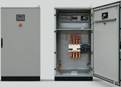
1000-1250 A Conmutador motorizado de 4 polos. Central CEC7. Detección fallo de red. Parada de emergencia. Medición de tensión.
