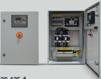
30-125 A Contactores de 4 polos. Central CEC7. Detección fallo de red. Parada de emergencia. Medición de tensión.
