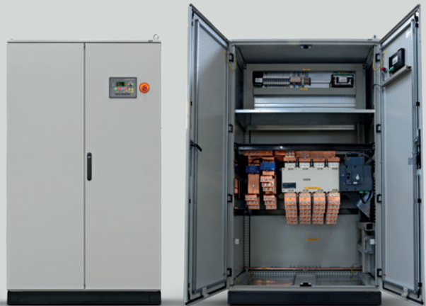
2500-3150 A Conmutador motorizado de 4 polos. Central CEA7. Detección fallo de red y control de grupo. Parada de emergencia. Medición de corriente y tensión.
