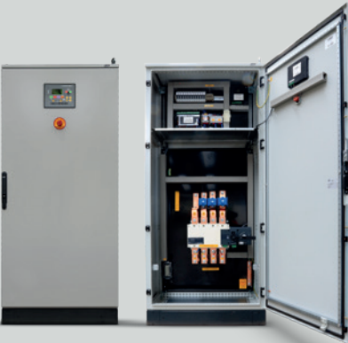
800 A Conmutador motorizado de 4 polos. Central CEA7. Detección fallo de red y control de grupo. Parada de emergencia. Medición de corriente y tensión.
