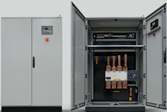
1600 A Conmutador motorizado de 4 polos. Central CEA7. Detección fallo de red y control de grupo. Parada de emergencia. Medición de corriente y tensión.
