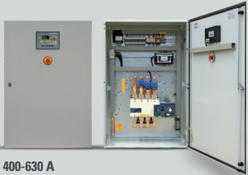
400-630 A Conmutador motorizado. Central CEA7. Detección fallo de red y control de grupo. Parada de emergencia. Medición de corriente y tensión.
