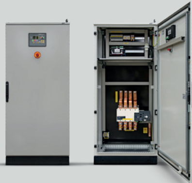
800 A Conmutador motorizado de 4 polos. Central CEC7. Detección fallo de red. Parada de emergencia. Medición de tensión.
