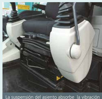
La suspensión del asiento absorbe la vibración
