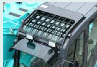
Protección SUPERIOR (Nivel II) montada como estándar.
