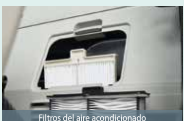
Filtros del aire acondicionado
