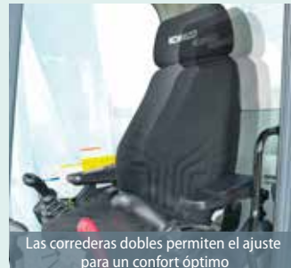
El respaldo del asiento puede inclinarse hasta la horizontal
