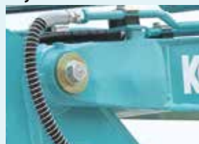
Parte superior del balancín forjada
