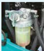
Prefiltro de combustible con separador de agua integrado
