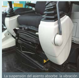
La suspensión del asiento absorbe la vibración
