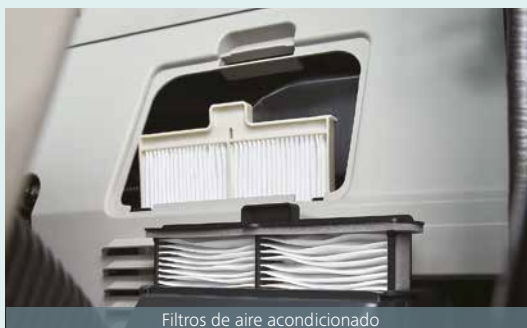
Filtros de aire acondicionado
