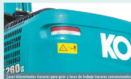
Luces intermitentes traseras para girar y luces de trabajo traseras convencionales
