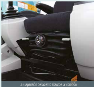
La suspensión del asiento absorbe la vibración
