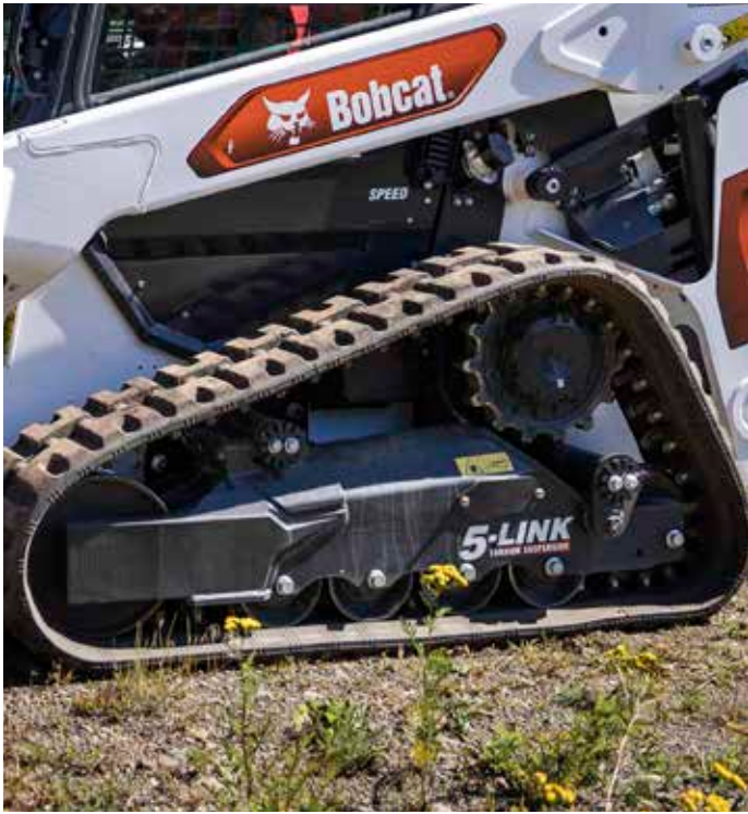
Tren inferior con suspensión de torsión de 5 articulaciones
